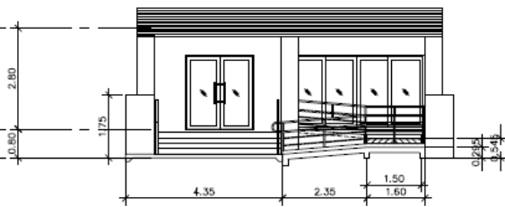
รูปตัดขยายทางลาดสำหรับผู้พิการ ขนาดส่วน 1 : 50 (A1)
